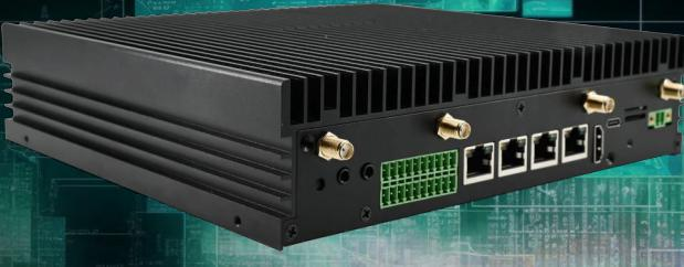
MES20是一款高性能、低功耗的深度学习边缘智算微服务器产品，搭建国产自主知识产权的边缘AI SoC处理器EA6530，可同时处理16路高清视频解码，最高支持24TOPS(INT8)/ 12TFLOPS(FP16)深度学习神经网络算法推理能力，支持主流深度学习框架，接口丰富，支持USB, HDMI, RS485等接口，支持风扇散热和宽温工作。
