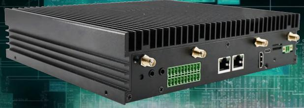
MES15是一款高性能、低功耗的深度学习边缘智算微服务器产品，搭建国产自主知识产权的边缘AI SoC处理器EA6518，可同时处理16路高清视频解码，最高支持16TOPS(INT8)/ 8TFLOPS(FP16)深度学习神经网络算法推理能力，支持主流深度学习框架，接口丰富，支持USB、HDMI、RS485等接口，支持风扇散热和宽温工作。
